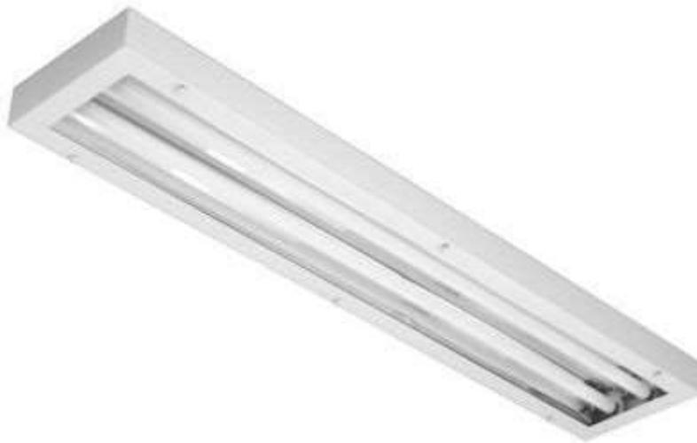
Luminária hermética de sobrepor, com corpo em chapa de aço fosfatizada e pintada eletrostaticamente, refletor facetado em alumínio anodizado de alta pureza e refletância, difusor em vidro temperado transparente e vedação através de borracha autoadesiva.
