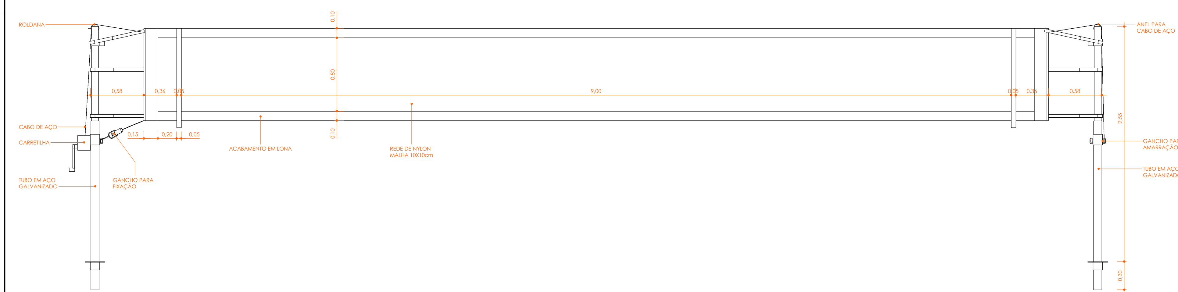
DETALHE REDE DE VÔLEI ESC: 1 : 25
